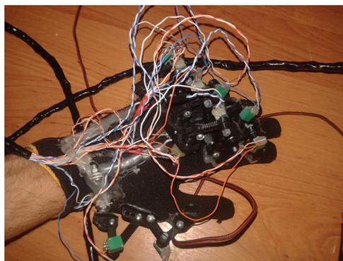
**Рисунок 3. Устройство для управления манипулятором**
