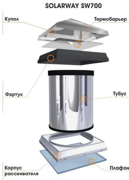
**Рисунок 1. Схема полого трубчатого световода**
