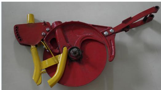
**Рисунок 2. Модель комбинированного сошника с U-образным загортателем**
