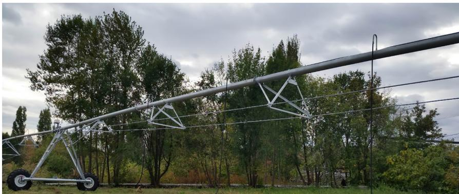
**Рисунок 1. Опытный образец дождевальной машины
